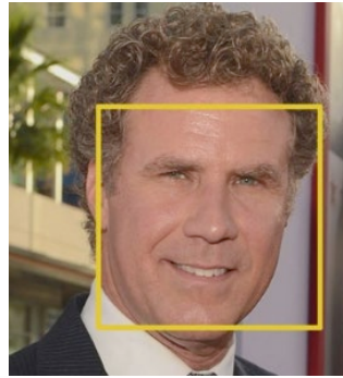
Figure 55 ผลลัพธ์จากการค้นหาตำแหน่งใบหน้าด้วย Histogram of Oriented Gradients (HOG)
